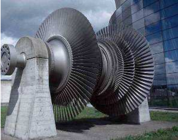
Rotore di una turbina a vapore
