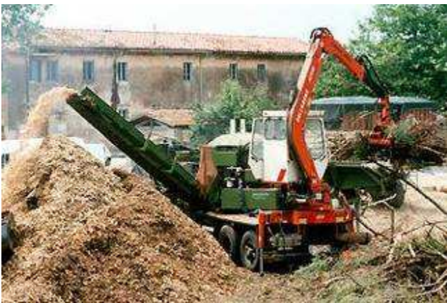
Produzione di cippato da scarti di vegetazione
