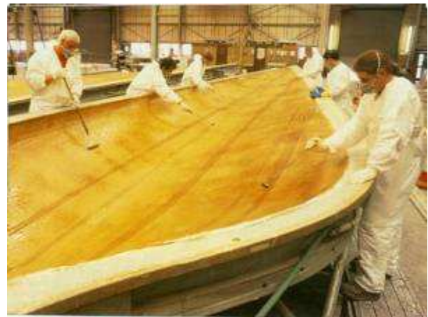
Formatura manuale di una pala per aeromotore
