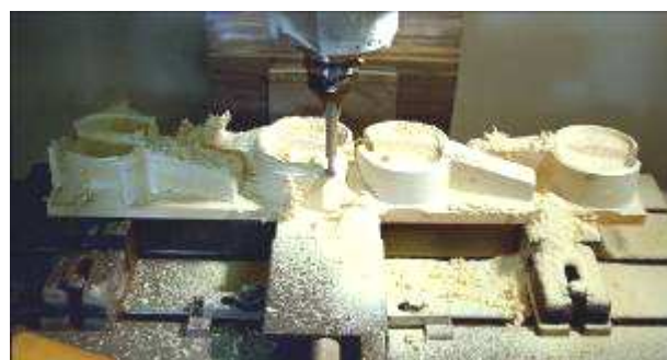
Lavorazione di modelli di pala Pelton
